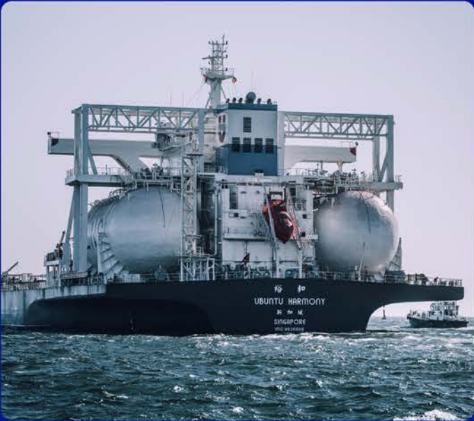
Ubuntu Harmony es el primero de 10 buques híbridos de LNG recién construidos que ya brindan una reducción significativa en las emisiones de gases de efecto invernadero, en comparación con los buques de combustible marino tradicional. Además, elimina la emanación de metano sin quemar.
