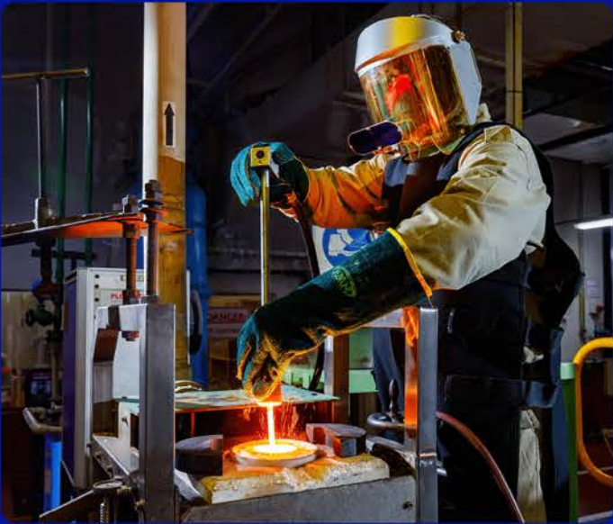
Fundición de lingotes de paladio en el fundidor de metales preciosos de PGM, Rustenburg, Sudáfrica.
