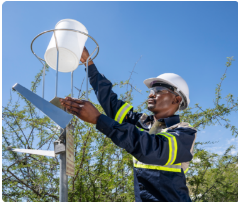
Análisis de polvo para el monitoreo ambiental en nuestra mina de Mogalakwena en Sudáfrica.
