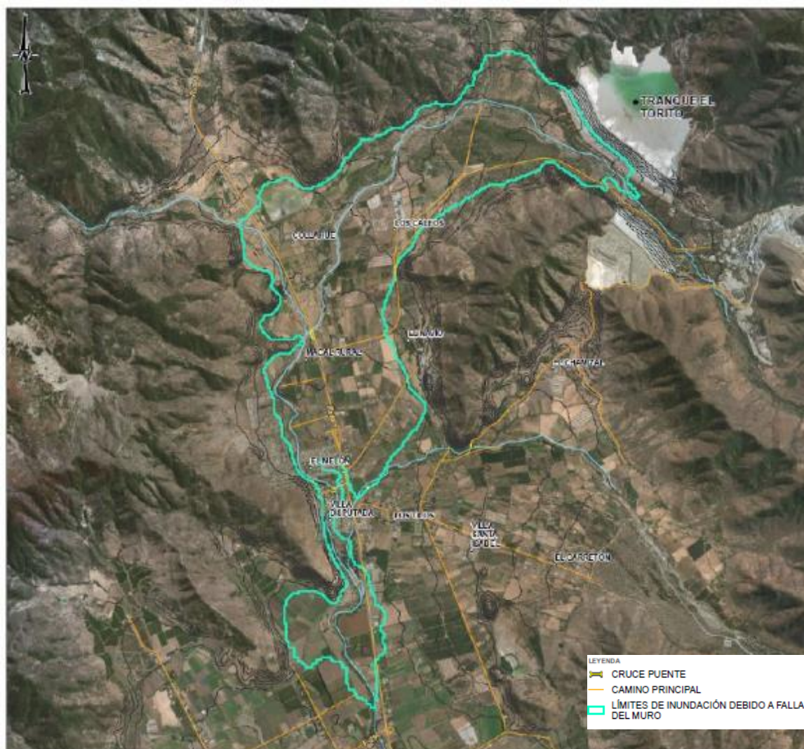
Figura 4. Zona de Inundación del Tranque de Relaves El Torito 235ton
