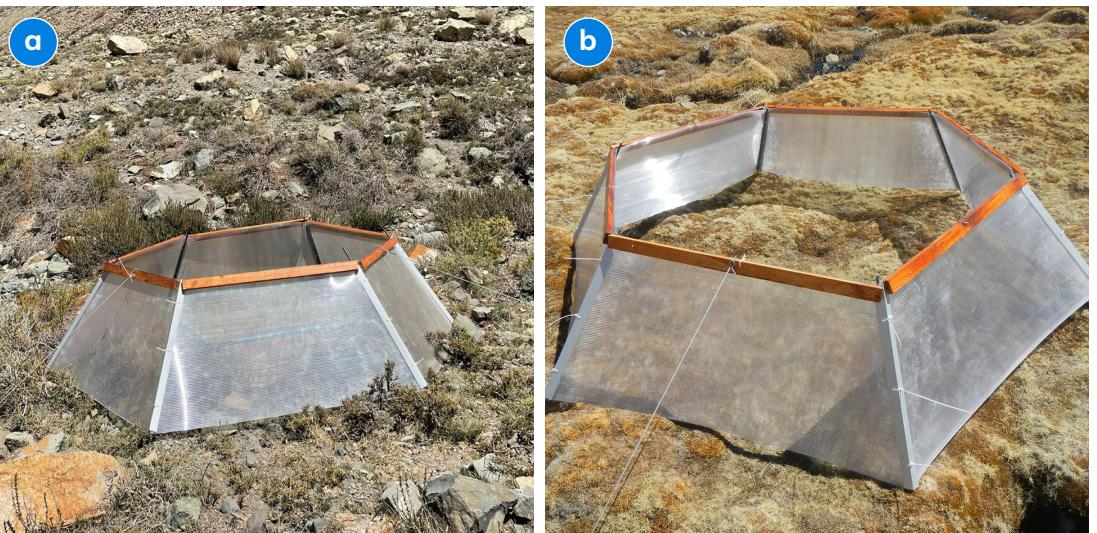
Figura 8. Cámaras de crecimiento de techo abierto instaladas en a) matorral altoandino y b) bofedal altoandino.
